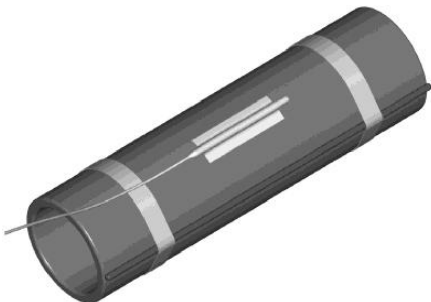
Рисунок F.1 - Типичная установка датчика системы управления и датчика термореле
