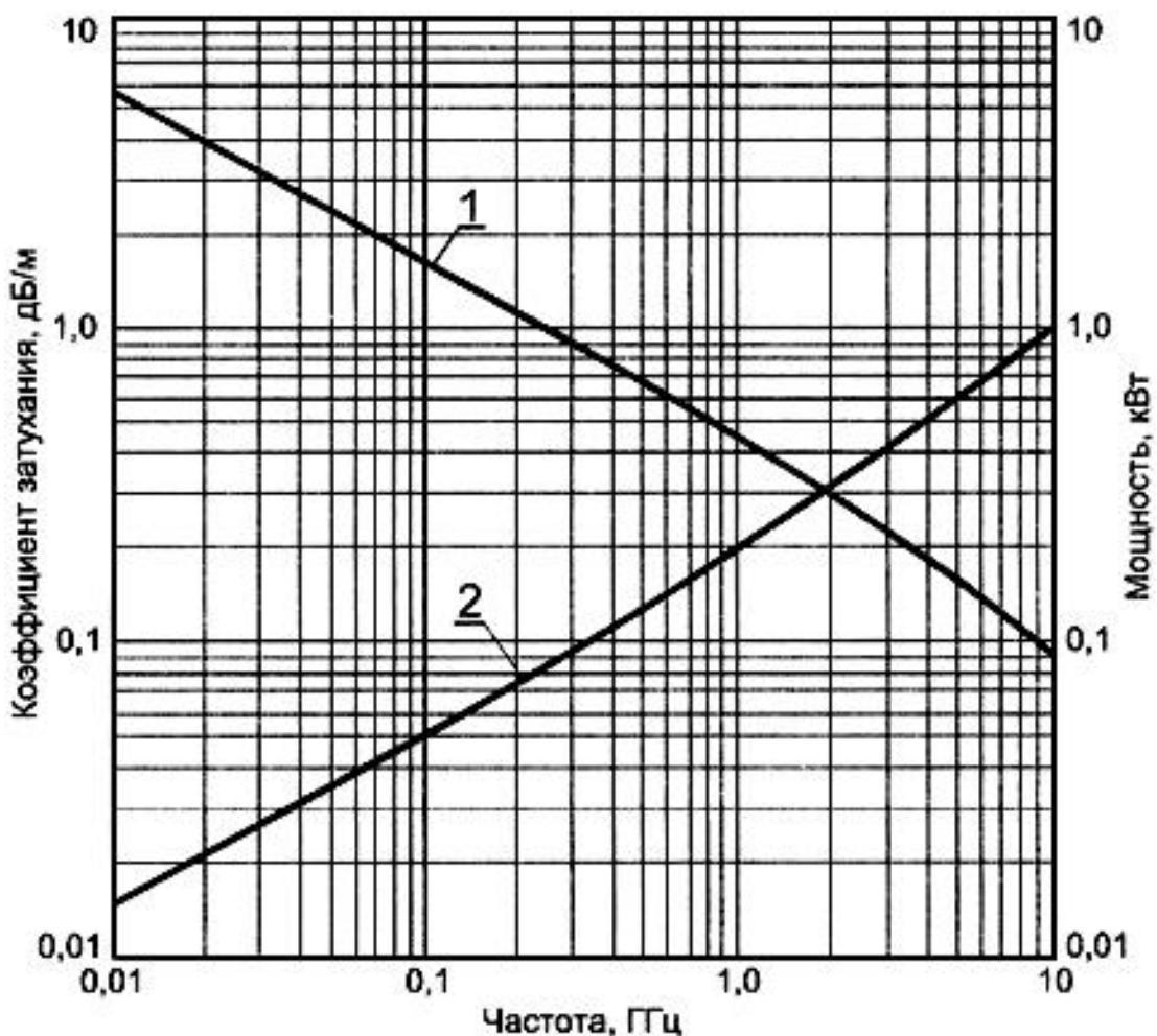
1 - допустимая мощность  $P$  на входе при температуре 40 °С и коэффициенте стоячей волны
