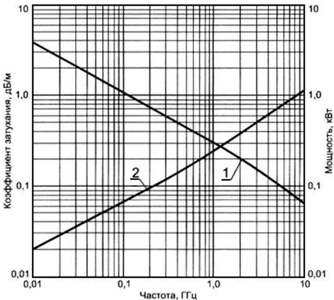
1 - допустимая мощность  $P$  на входе при температуре 40 °C и коэффициенте стоячей волны
