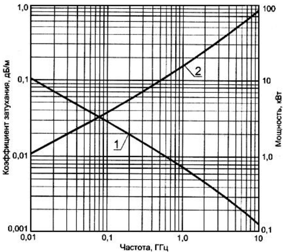
1 - допустимая мощность  $P$  на входе при температуре 40 °C и коэффициенте
